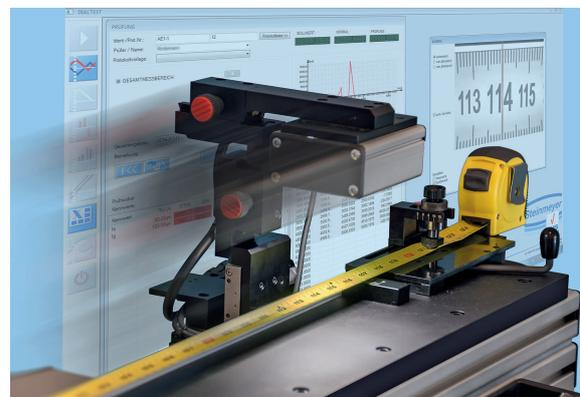
Feinmess Suhl bietet als einziges Prüflabor in Deutschland die Kalibrierung von Längenmessern bis zehn Metern an. © Feinmess Suhl GmbH
